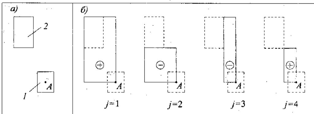
а — схема расположения рассчитываемого  $l$  и влияющего фундамента 2; б — схема расположения фиктивных фундаментов с указанием знака напряжений  $\sigma_{zp,j}$  в формуле (5.21) под углом  $j$ -го фундамента
