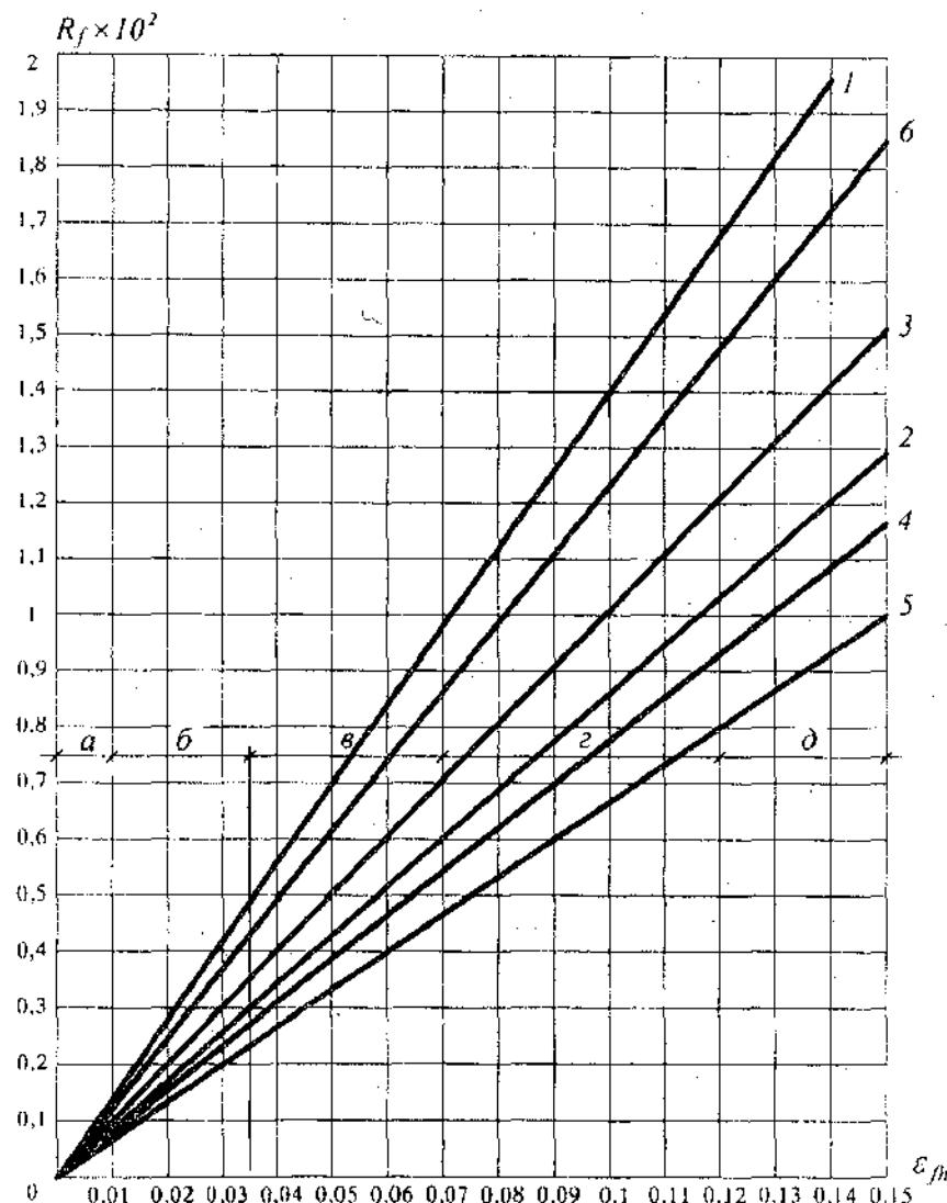
1, 2 — супеси; 3 — суглинки; 4 — суглинки с  $0,07 < I_p \leq 0,13$ ; 5 — суглинки с  $0,13 < I_p \leq 0,17$ ; 6 — глины (в грунтах 2, 4 и 5 содержание пылеватых частиц размером 0,05—0,005 мм составляет более 50 % по массе); а — практически непучинистый; б — слабопучинистый; в — среднепучинистый; г — сильнопучинистый; д — чрезмернопучинистый
