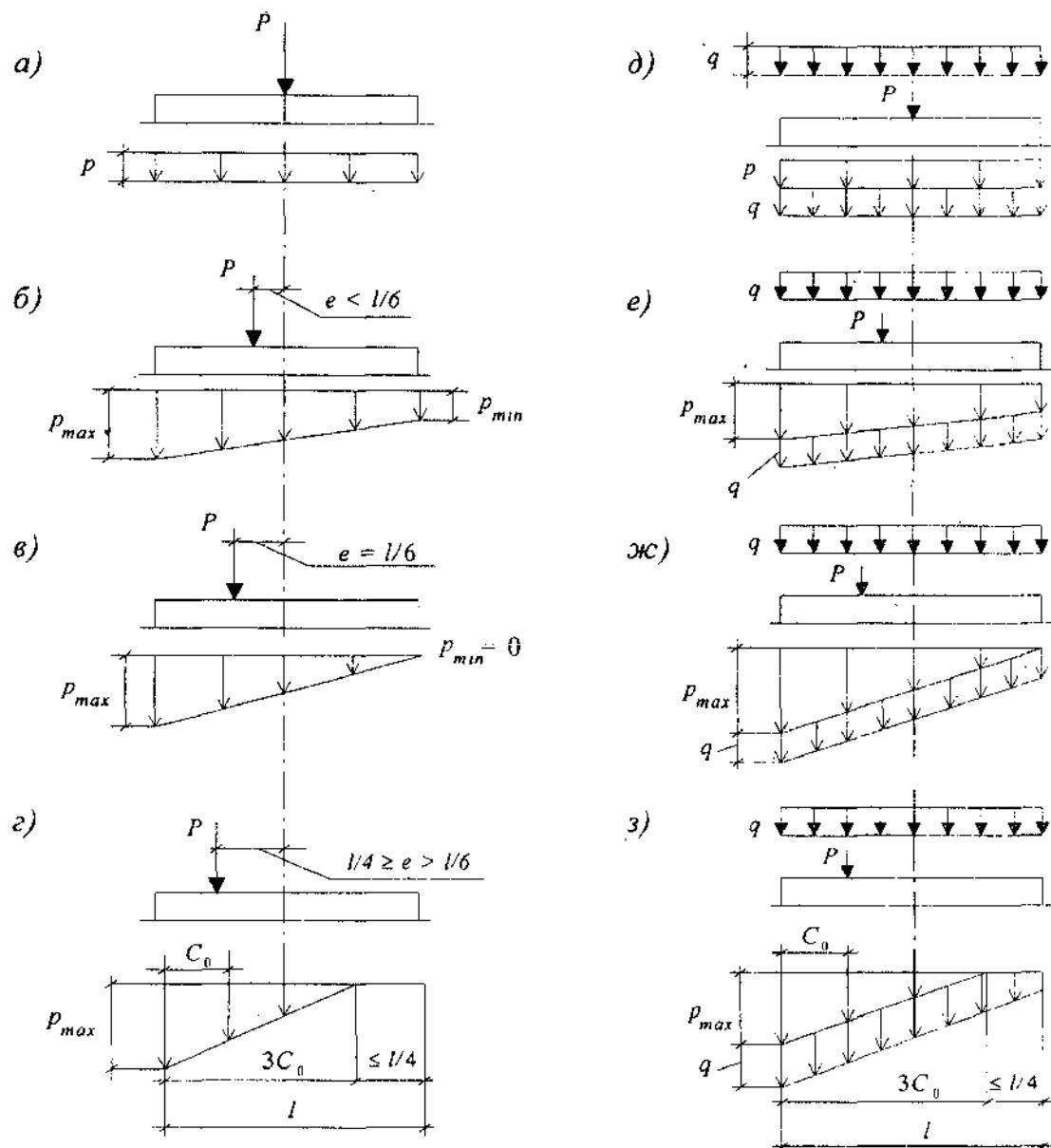
а—г — при отсутствии нагрузок на полы; д—з — при сплошной равномерно распределенной нагрузке интенсивностью  $q$ ; а и д — при центральной нагрузке; б и е — при эксцентриситете нагрузки  $e < l/6$ ; в и ж — при  $e = l/6$ ; г и з — при  $e > l/6$  (с частичным отрывом фундамента от грунта)
