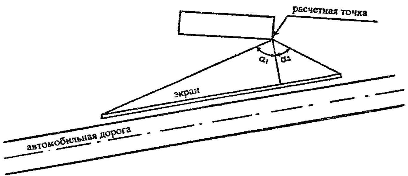
Рис.4.6.2. Схема расчета длины противошумового экрана.
