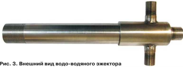
Рис. 3. Внешний вид водо-водяного эжектора центрального типа со съёмным соплом и камерой смешения (габаритные размеры эжектора (ДхШхВ, мм) – 430х60х160)
