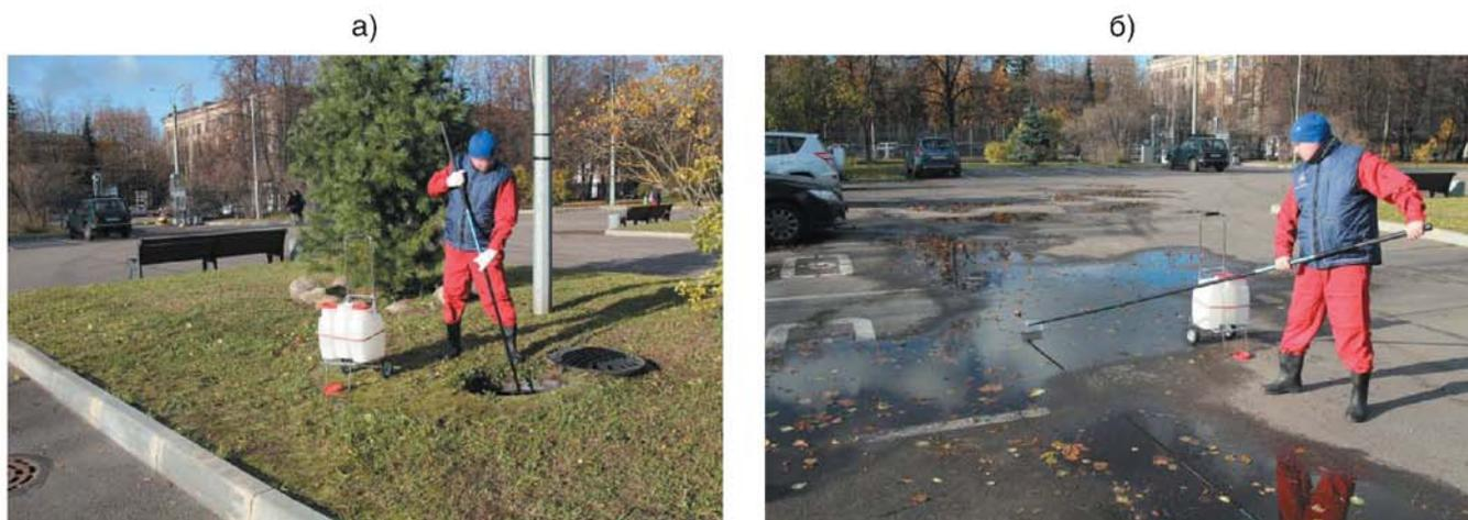
Рис. 4. Отбор проб из канализационных колодцев установки комплексной доочистки поверхностного стока
