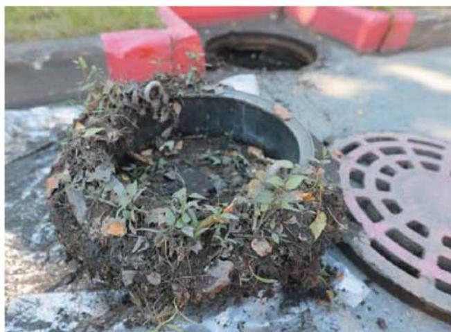
Рис. 4. Фильтр ФОПС®-К-0,58 по окончании испытаний
