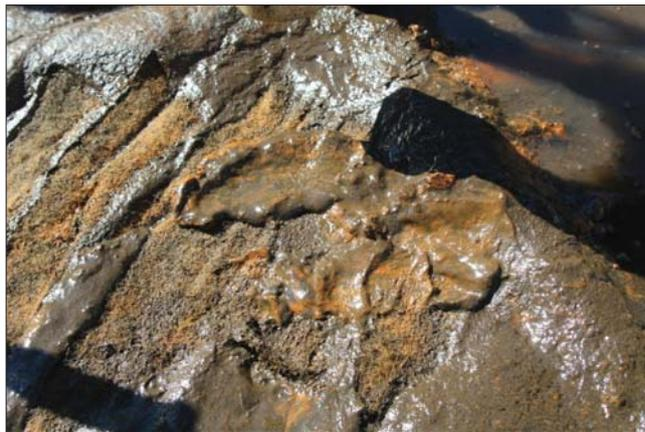
Рис. 8. Внешний вид осадка, образовавшегося к концу периода испытаний, на фильтрующем материале фильтра ФОПС®-Ц-1,5-1,2
