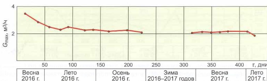
**Рис. 4. Изменение максимального расхода воды через фильтр ФОПС®-МУ-0,58-1,8 во время интенсивной фазы дождя за период испытаний**
