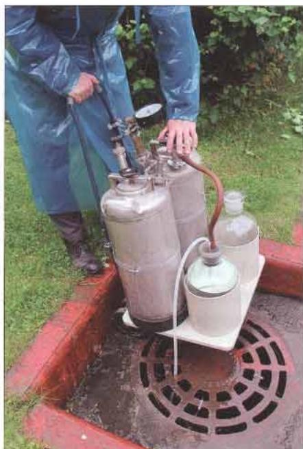
**Рис. 3. Устройство для вакуумного пробоотбора при его работе на объекте**
