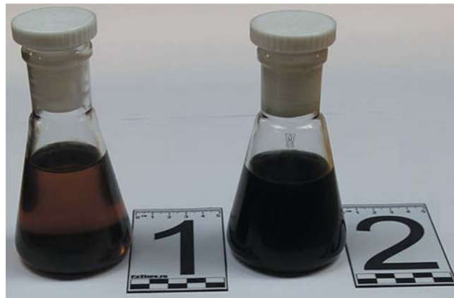
Рис. 7. Внешний вид жидких нефтепродуктов, накопившихся в фильтре ФОПС®-С
