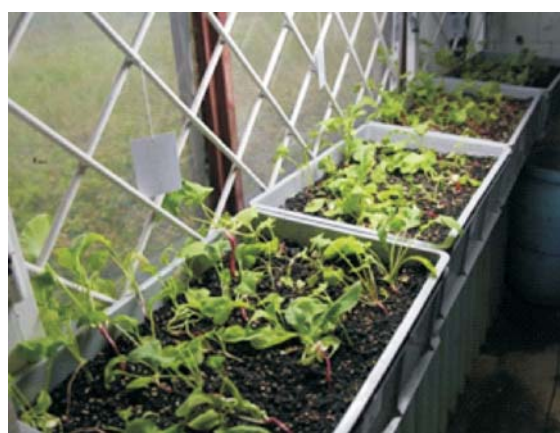
Рис. 3. Внешний вид вегетационных сосудов с растениями редиса ФЗ, выращенных на различных ПГС: ПГ + (0 об. %; 10 об. %; 20 об. %; 40 об. % ПЦ)
