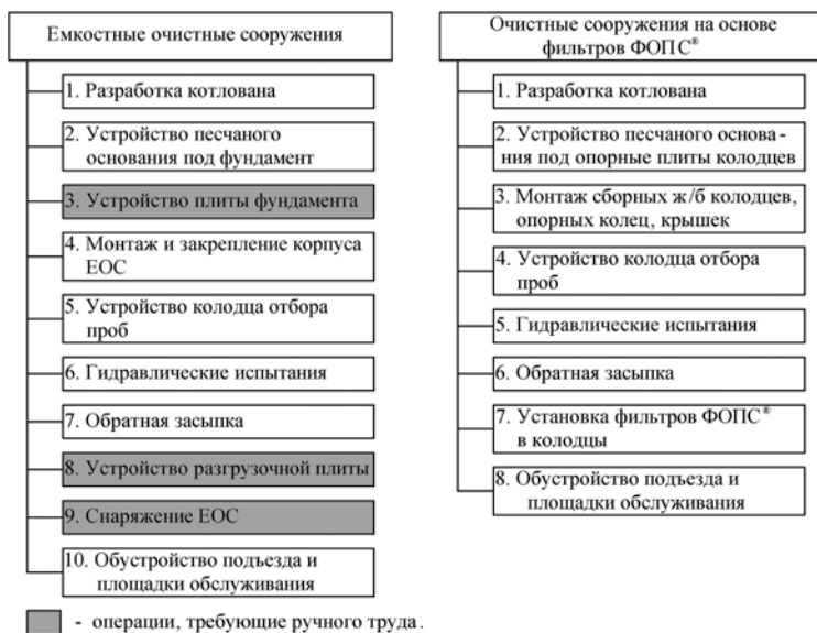
Рис. 3. Блок-схемы технологий строительства очистных сооружений типа ЕОС (на основе полимерных емкостей) и сооружений на основе фильтров ФОПС® и стандартных ж/б колодцев
