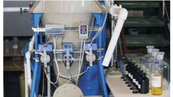
**Рис. 1. Стенд для создания и поддержания заданных концентраций растворимых форм ТМ**
